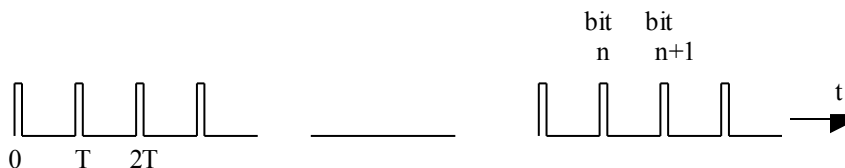
Figure 9.17 Impulsions de synchronisation du système numérique
