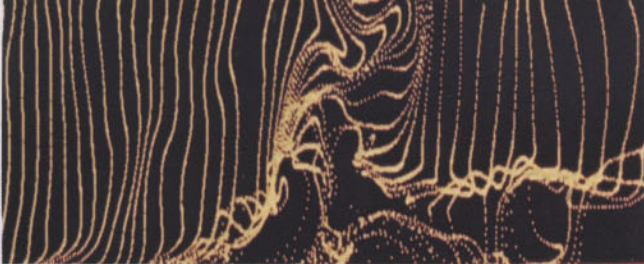
3. SIMULATION DES TRAJECTOIRES de particules dans un fluide turbulent s'écoulant entre deux plaques (à gauche), réalisée en 1980 à l'Université de Stanford. Obtenue à l'aide d'un des tout premiers ordinateurs
