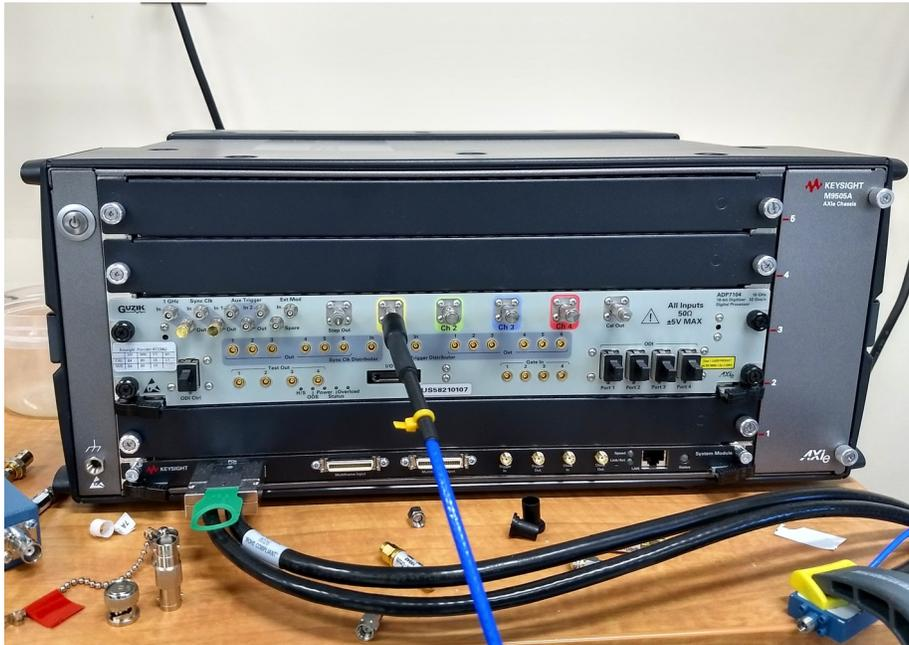
FIGURE 8.3 – Guzik ADP7104 dans châssis Keysight M9505A. Les quatre ports SMA identifiés par des fonds colorés correspondent aux canaux d’acquisitions. Les ports de synchronisation « 1 GHz » et « Sync Clk » sont visibles en haut à gauche du panneau de la carte. La communication avec le poste de travail est assurée par le câble double branché au panneau inférieur.
