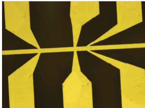
Figure 3.8 La zone centrale d'une des 4 barres de Hall définie par photolithographie sur un échantillon de SOI, montrant 6 des 8 amenés de courant. En jaune, les zones masquées et en brun, les zones non masquées qui vont être gravées (procédé FIB).
